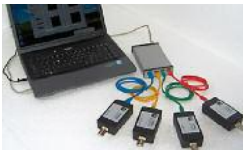
Quartz Crystal Microbalance multicanale, per misure in aria e in liquido, completa di camere di misura statiche e a flusso
