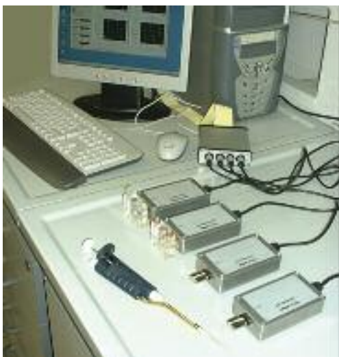
Quartz Crystal Microbalance multicanale, per misure in aria e in liquido, completa di camere di misura statiche e a flusso
